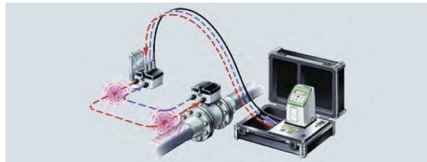
Тестування ізоляції перетворювача
